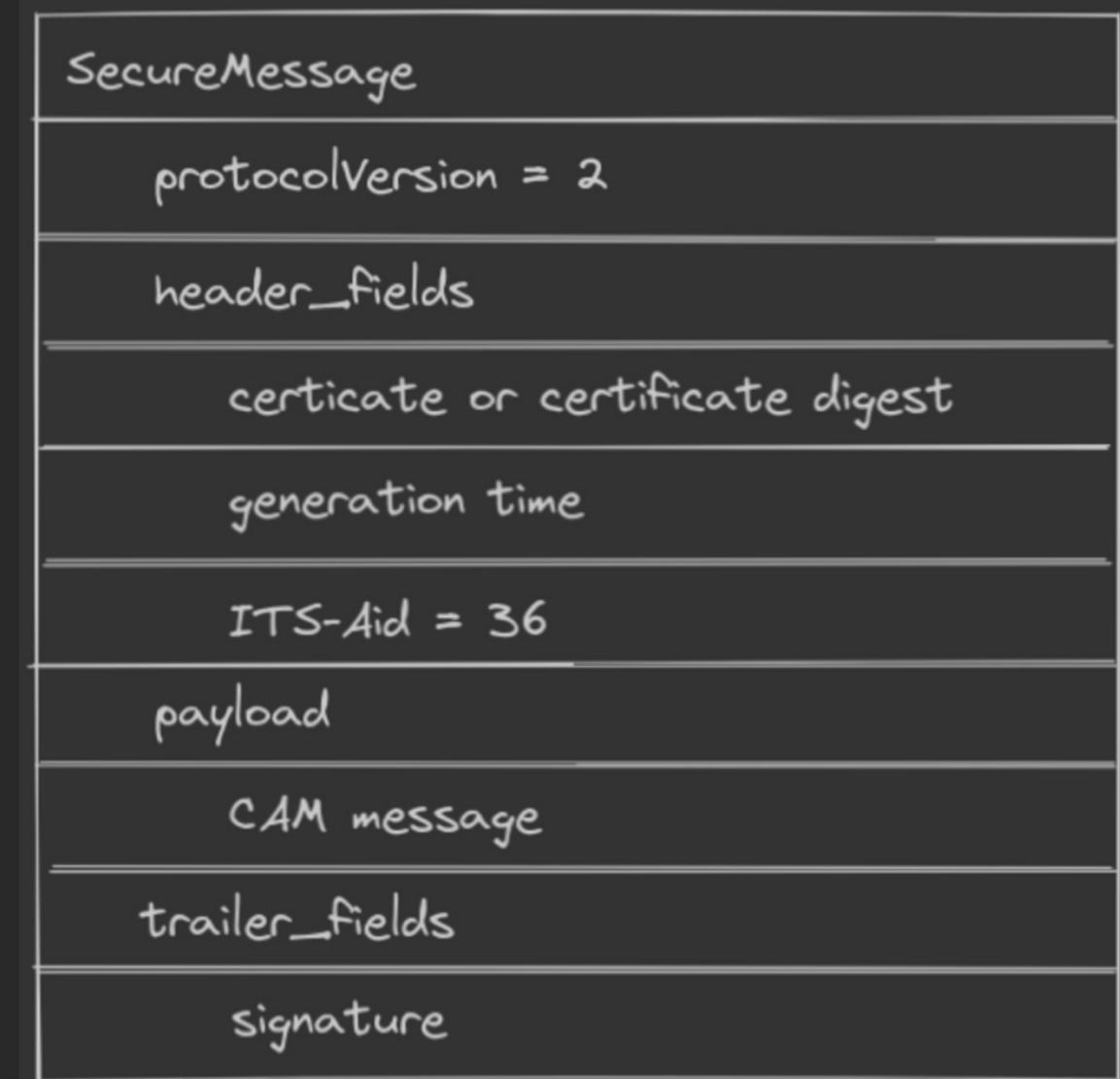
Structure d'un secure message dans le cadre de l'envoi d'un message CAM
